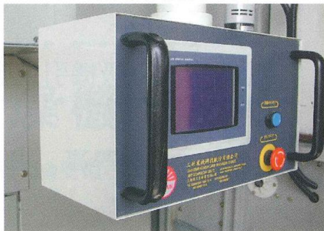
PLC 控制系統/觸控銀幕
