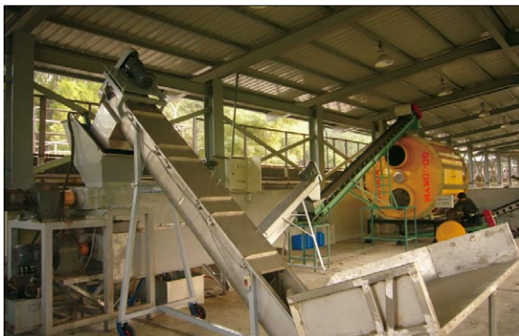
圖1 農產廢棄物堆肥化處理系統
