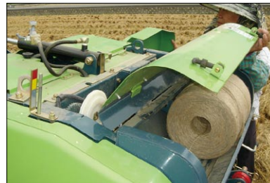
圖4 曳引機掛載之稻稈圓形打包機作業情形
