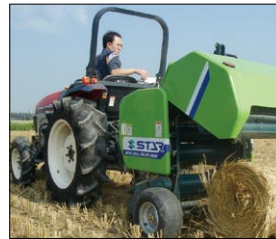
圖4 曳引機掛載之稻稈圓形打包機作業情形
