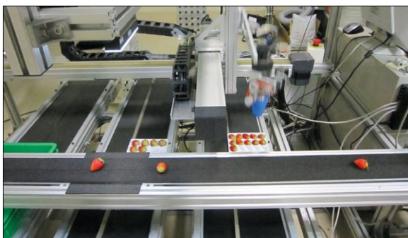
圖6 全自動草莓包裝機以機器手臂進行分級與整齊排列於包裝盒中
