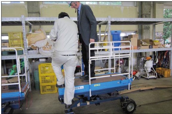
圖10 具有自動水平平衡功能之果園作業電動升降移動平台
