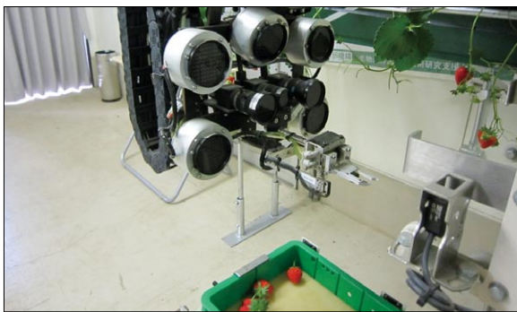
圖4 全自動草莓採收機的照明與取像系統
