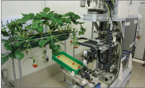
圖3 應用機器人與影像技術的全自動草莓採收機
