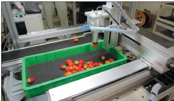
圖5 全自動草莓包裝機的草莓吸取裝置
