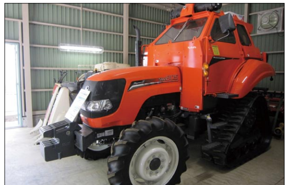
圖2 因應福島核災後重建需求所開發的抗輻射曳引機
