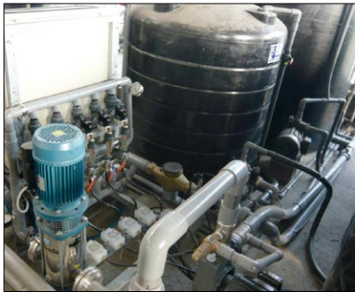
圖1 自動肥灌系統主機與管路架構，為典型的機電整合機具
