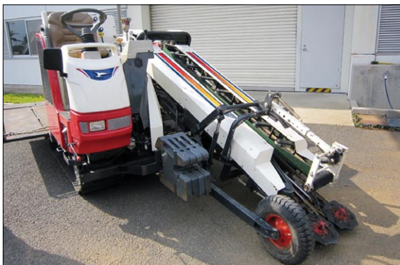
圖11 結合後段裝箱作業的甘藍收穫機
