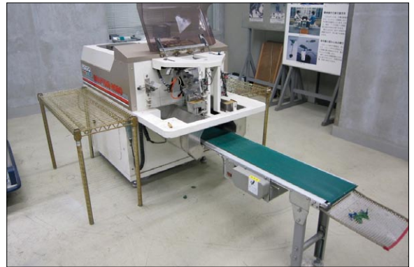
圖7 第一代已經商品化之半自動瓜類種苗嫁接機
