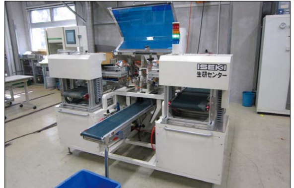
圖8 第二代之全自動瓜類種苗嫁接機
