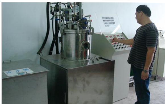
離心式瓜果種子溫湯消毒機人機介面操作台， 分手動式或自動式操控
