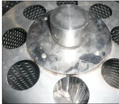
溫湯槽內之離心旋轉槽裝置
