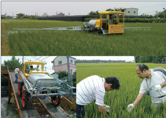
圖9 農機性能測定之情況舉例(高架桿式噴藥機性能測定)
