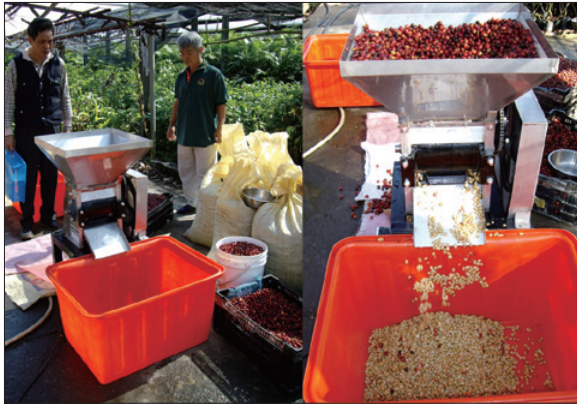
圖8 農機性能測定之情況舉例(咖啡果實去皮機性能測定)
