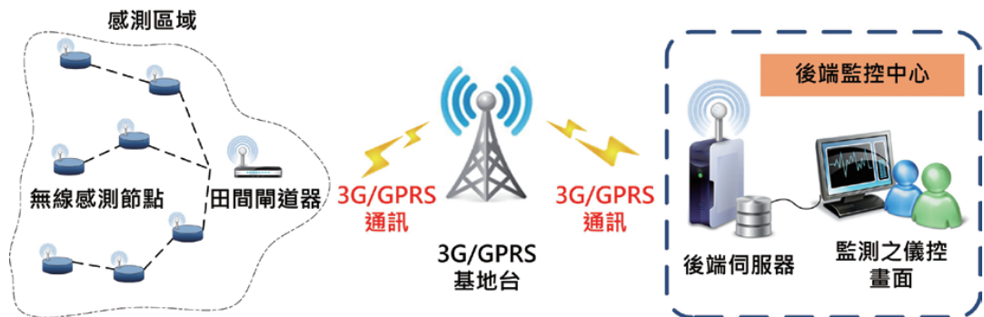
圖1 遠距型農業害蟲動態監測網
