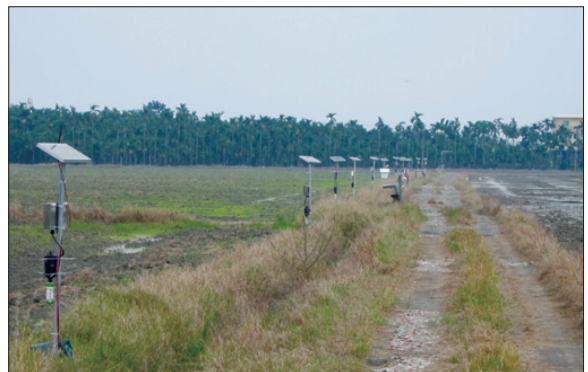
圖15 本研究團隊於屏東縣崁頂鄉毛豆田內使用綜合導向型閘道器的遠距型農業害蟲動態監測網(斜紋夜盜蛾)
