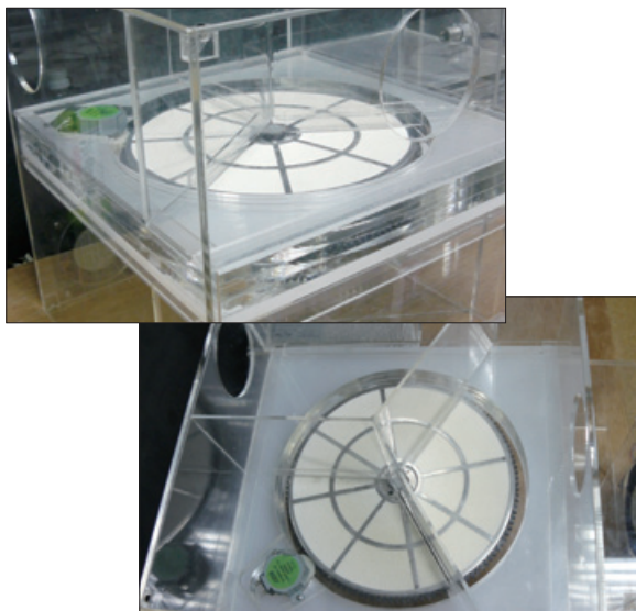
圖8 再生、冷卻與除濕區域各1/3之除濕輪配置情形
