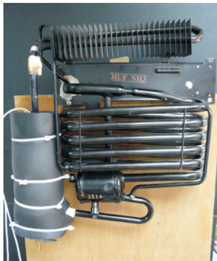
圖6 (左) 露營用瓦斯冰箱；(右) 瓦斯冰箱之內部配置情形。 其中，太陽能熱水於左下方以絕熱綿包覆區域進行熱交換。
