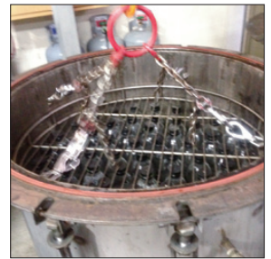
立式殺菌釜—電熱加熱
