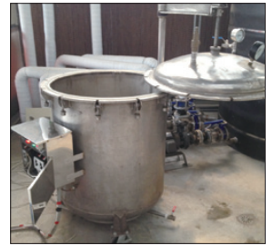
立式殺菌釜—電熱加熱
