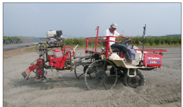
在駕駛座後方安裝的離合器控制桿及油門轉盤可控制開溝器運轉及轉速
