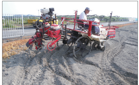
於田間作業轉彎時可透過插秧機的插植部抬升桿將附掛的紅豆開溝播種機構抬起
