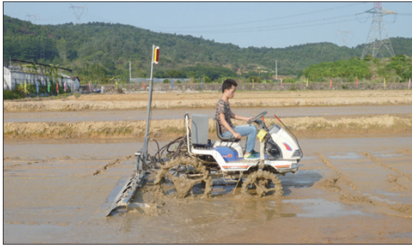
水田自動雷射整平系統之作業情形
