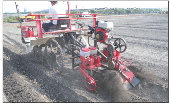
以本研究試製之紅豆開溝播種機田間測試播種及開溝覆土
