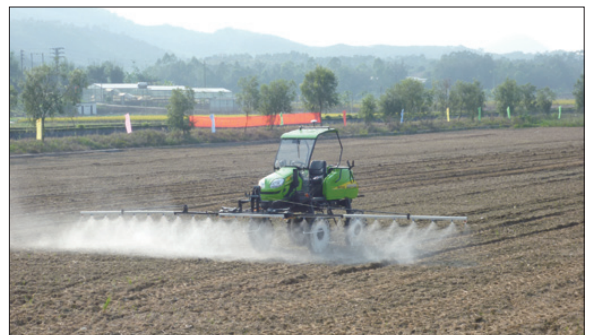
無人化自動導引噴霧車作業情形
