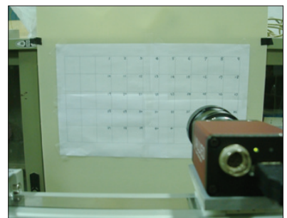
圖3 單鏡頭立體視覺 系統量測精準度 測試
