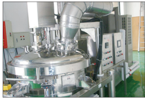
圖3 微波冷凝乾燥設備
