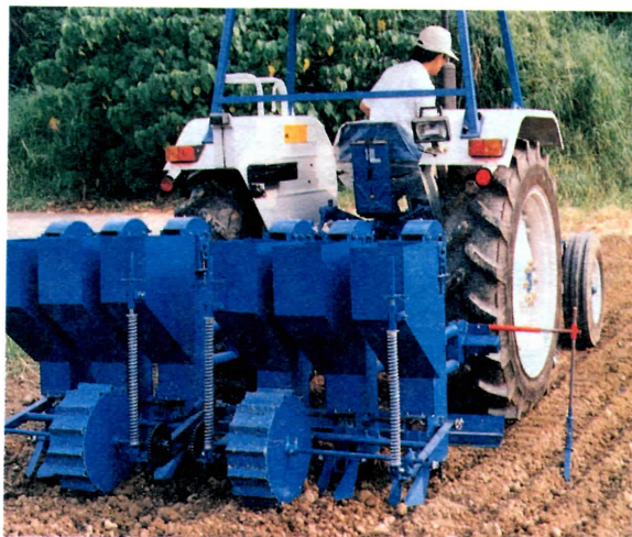
圖一 六行杯杓式大蒜播種機
