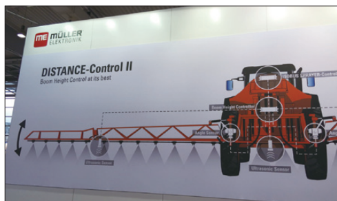
圖14 施藥機噴桿水平穩定度自動調整系統
