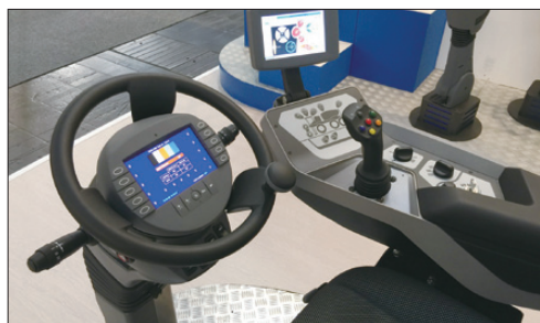
圖15 具有符合人因工程之人機界面的操控方向盤及把手
