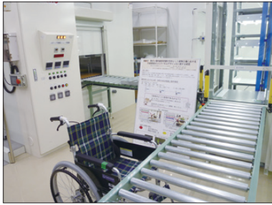
圖14 植物工廠進行內部操作之人因工程分析，並開發適合殘障人士(工作人員)操作之各項動線與面板設計
