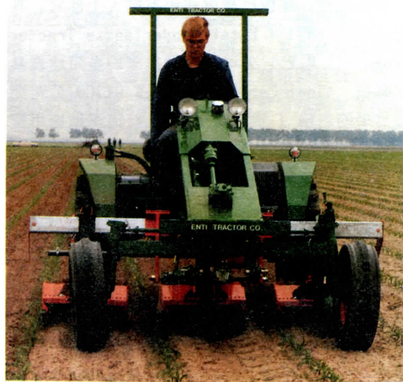
圖三 農具承載機田間作業情形
