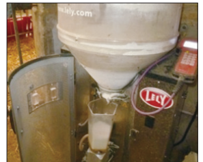
圖68 小牛自動餵飼系統全自動配製新鮮牛奶(Lely Calm)
