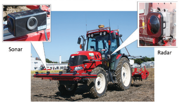
圖2 利用聲納與雷達感測器可偵測田間機器人與障礙物的距離 (北海道大學野口伸教授提供)
