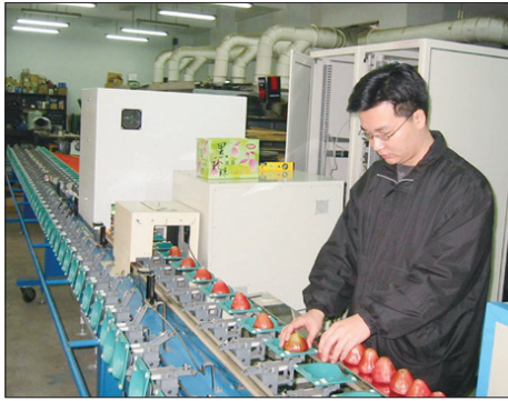
圖6 使用機器視覺及近紅外光檢測系統進行水果分級 (台灣大學陳世銘教授提供)
