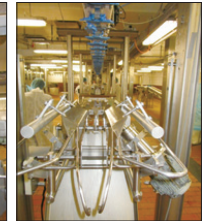
圖75 依照機械脈流將家禽水禽雙翼撐開，預備進行表皮切割
