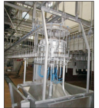
圖76 使屠體脹大的沖水注入設備，以方便去除內臟
