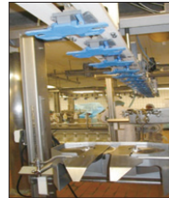
圖74 家禽水禽頭下腳上的頭部切割設備
