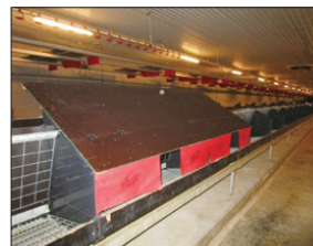
圖90 位於兩側的產蛋箱設置在雞蛋輸送帶上
