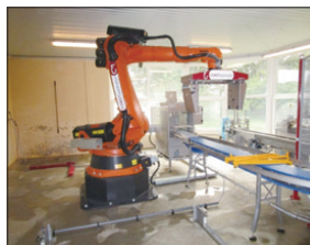
圖85 Vinni Larsen layer poultry farm使用KUKA機械手臂進行種蛋品集裝搬運作業
