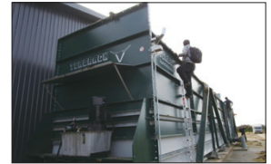
圖104 大型固態生質原廢料自動化翻堆設備，設計的儲料量為240 CMD
