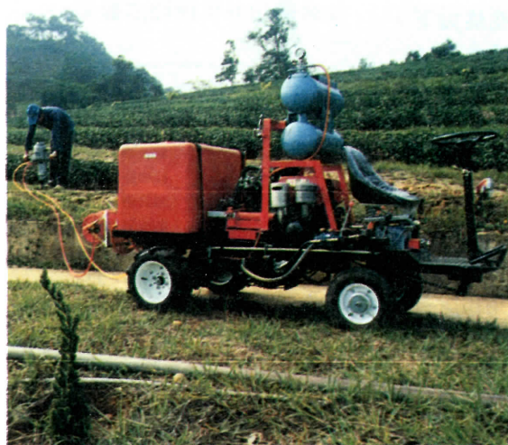
坡地茶園多用途作業機作深層鬆土施液肥情況
