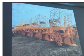
圖57 臺商谷林科技有限公司甘蔗種植機
