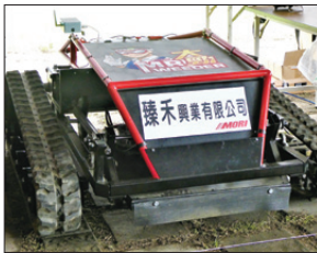
圖25 臻禾興業履帶式遙控割草機
