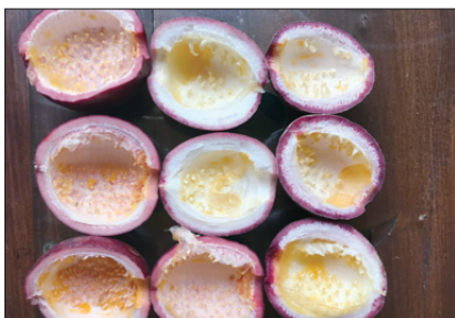
圖7 經過果漿抽取管正負氣旋交互作用抽吸後之果殼內部情形
