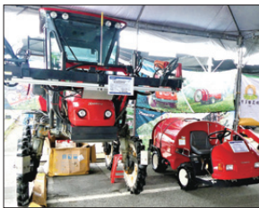
圖29 KIORITZ乘坐式桿式噴藥車(冷氣房型)
