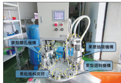
圖2 百香果取漿機械之果粒轉盤機構與其所對應的各部作業作用位置圖。
