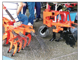
圖12 (左)附掛式旱田除草機，(右)溝底式旱田除草機
