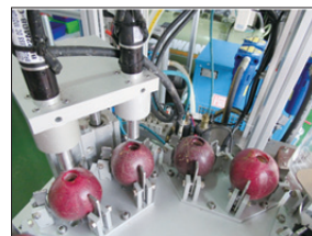
圖3 利用鑽頭銑孔刀進行果殼的表皮開孔之情形
