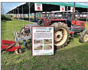
圖9 曳引機附掛甘藷去藤收穫一貫作業機
