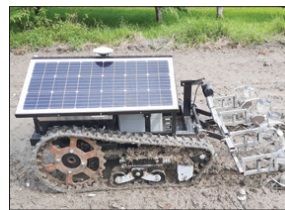
圖6 四行附掛式雜糧播種裝置附掛於無人自走車田間作業情形
