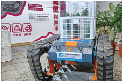
圖1 工研院中分院與機械所開發之載重搬運車
