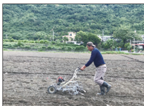
圖2 自走式小粒徑種子播種機的田間作業情形
