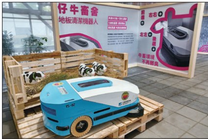
圖2 農委會畜試所與工研院中分院所開發之仔牛畜舍地板清潔機器人
