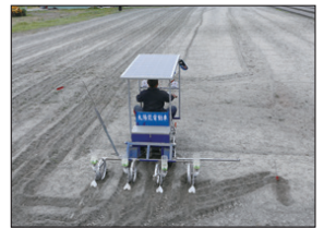
圖5 四行附掛式雜糧播種裝置附掛於太陽能車田間作業情形
