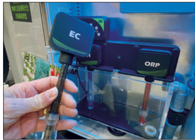
圖39 四合一水質感測器-用於監測溫度、pH、EC、ORP等水質數據
