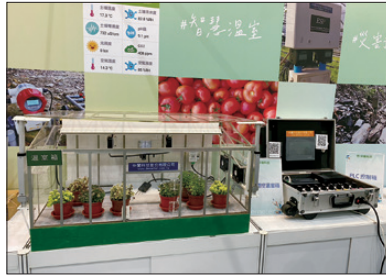
圖9 智慧溫室PLC環控模型
