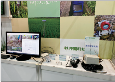
圖8 大田智慧灌溉用感測器(光照感測器、溫濕度感測器、土壤pH感測器、淹水偵測感測器)
