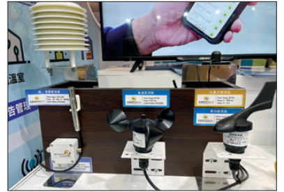
圖10 溫溼度感測器、風速感測器、風向感測器、光子感測器
