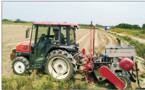
圖4 附掛式大蒜播種機田間作業情形
