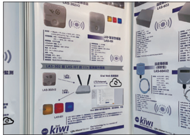
圖12 應用LoRa WAN傳輸技術之CO 2 與溫溼度感測器
