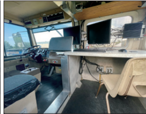
圖16 曳引機性能測試車駕駛艙內部與監控面板
