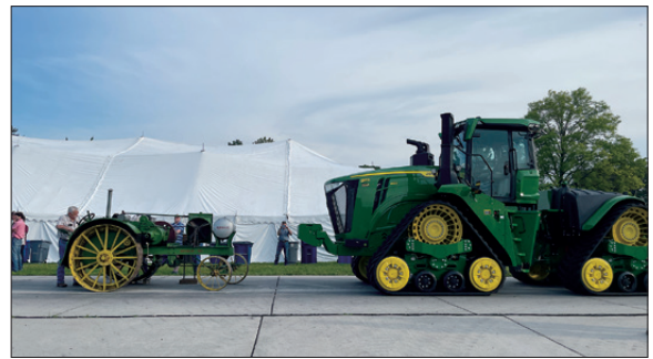
圖19 曳引機性能測試百年傳承。左側是1920年測試的第一部曳引機Waterloo Boy Model N，右側為2023年剛完成測試的John Deer 9RX 640曳引機
