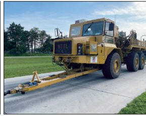
圖14 2002年由Caterpillar, Inc.製造的曳引機性能測試車與前方拉桿
