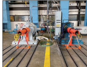
圖3 曳引機測試實驗室的兩部動力計 (Dynamometer)
