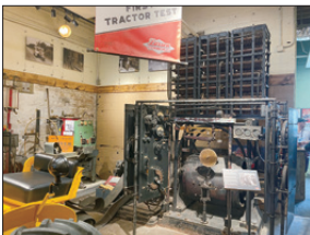
圖9 曳引機測試實驗室安裝於1919年的第一部Sprague 動力計
