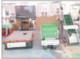
圖3 電動智能跟隨搬運機
