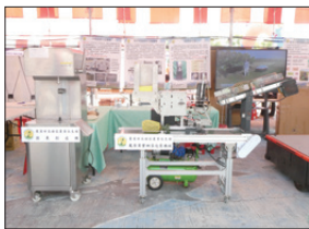
圖6 鳳梨果實網袋包裝機械(右)蔬果削皮機(左)
