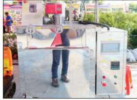
圖5 可遠端監控之茶葉烘培機
