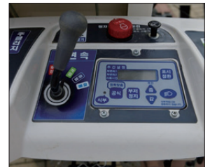
圖22 HSM農機公司的履帶式玉米苗全自動移植機儀表板
