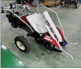
圖14 步行自走式單行雜糧收穫機
