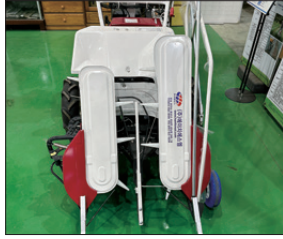
圖15 步行自走式雙行雜糧收穫機
