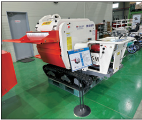
圖16 自走式動力脫穀機
