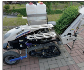
圖21 HSM農機公司生產的履帶式玉米苗全自動移植機，兩履帶輪可以形成高差，藉以適應傾斜的地形，而繼續作業。
