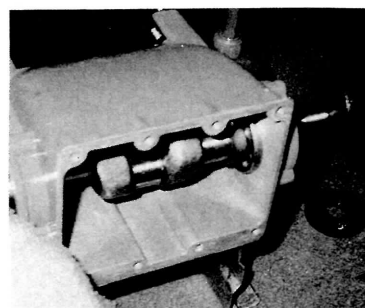
圖27 用塑膠榔頭敲出曲軸
